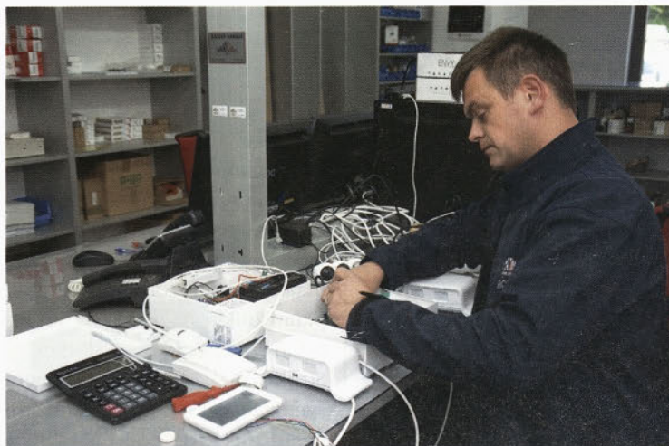
Boštjan Kukovec pripravlja protivolmno centralo za montažo
