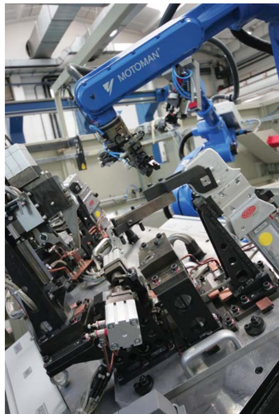
Slika 3: Robot za strego in ena od dveh dvojnih varilnih priprav
