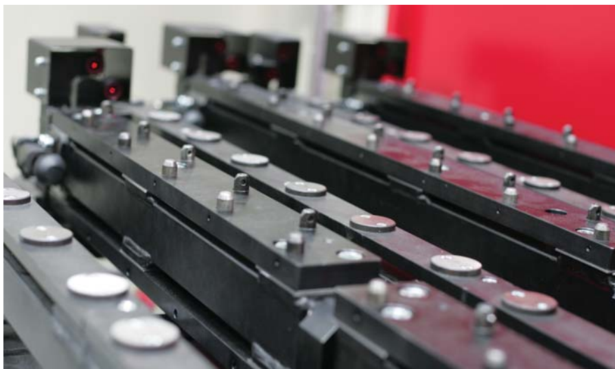
Slika 4: Nosilci gnezd z elementi za pozicioniranje in zaznavali
