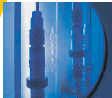
Slika 1: Zaščita zobnikov s plazemskim postopkom inženirstva površin (vir: Balzers)
