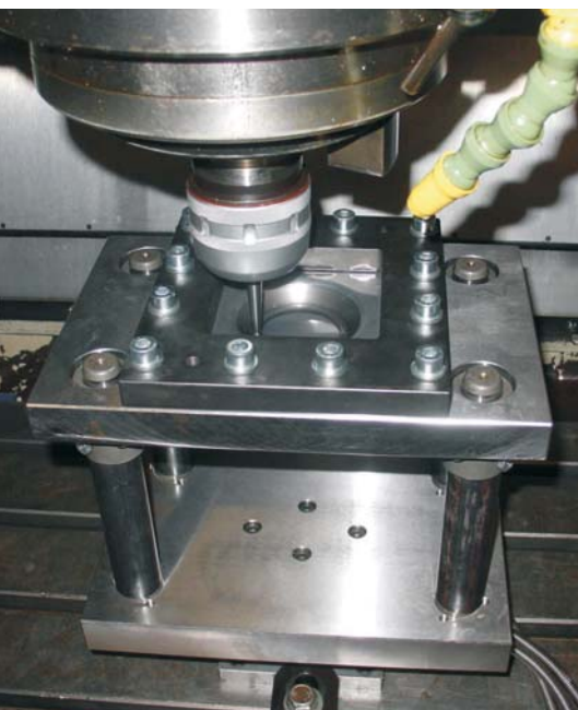
Slika 1: Princip enotočkovnega inkrementalnega preoblikovanja pločevine
