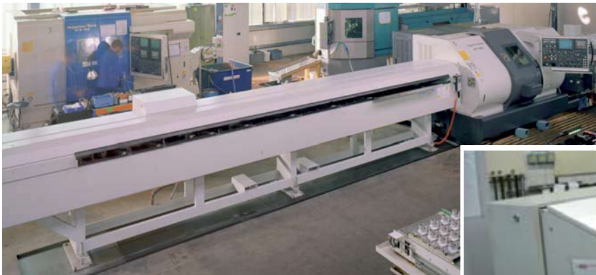
Enokanalni dodajalni magazin za 6.000 mm dolžine obdelovanca
