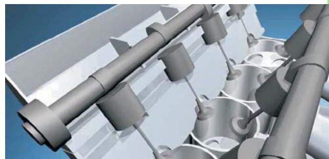
Slika 8: Za zaščito najbolj obremenjenih delov motorjev z notranjim izgorevanjem se najpogosteje uporabljata CrN- in DLC-prevleki.
