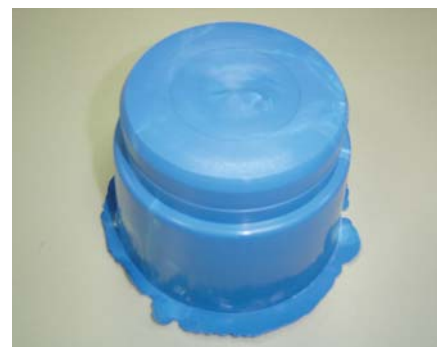
Slika 4: Močno prelit izdelek zaradi premajhne sile zapiranja
