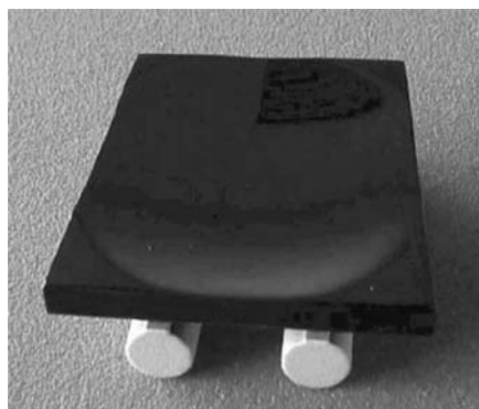
Slika 13: Primer uporabe prevlek DLC na kontaktnih površinah umetnega gležnja [22]
