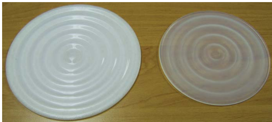
Izdelek, narejen z brizganjem penjenega silikona LSR (levo penjeni silikon, desno nepenjen)
