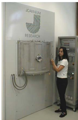
Slika 2: Sistem za lasersko uparjevanje z več izviri za industrijsko prekrivanje velikih površin z veliko hitrostjo nanašanja, ki je v Laser Center Leoben
