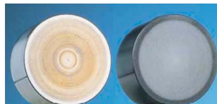
Slika 9: Dročnik dirkalnega motorja Kawasaki brez zaščitne prevleke po 250 km (levo) in prekrit z DLC-prevleko po 1000 km (desno). Neprekrit dročnik je obrabljen, prekriti pa je še primeren za uporabo. (vir: Balzers)
