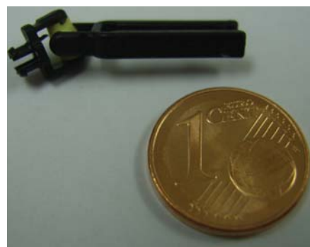
Miniaturni kardanski zglob, narejen z večkomponentnim mikromontažnim brizganjem
