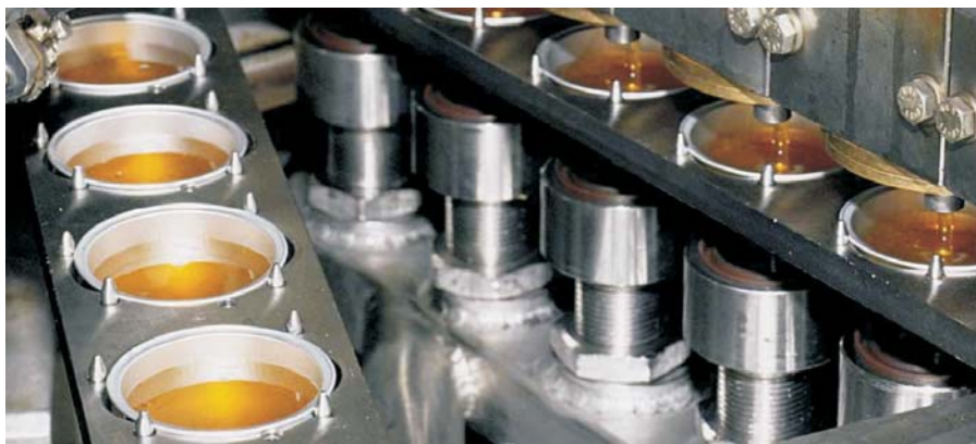
Slika 10: Dozirni bati za polnjenje želatine, zaščiteni pred korozijo s CrN-prevleko (vir: Balzers)
