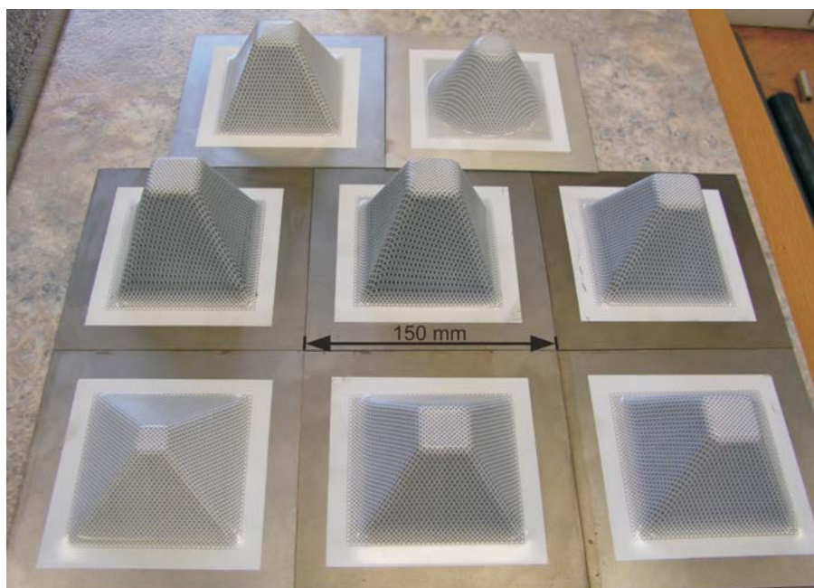
Slika 4: Primeri enotočkovnega inkrementalnega preoblikovanja pločevine
