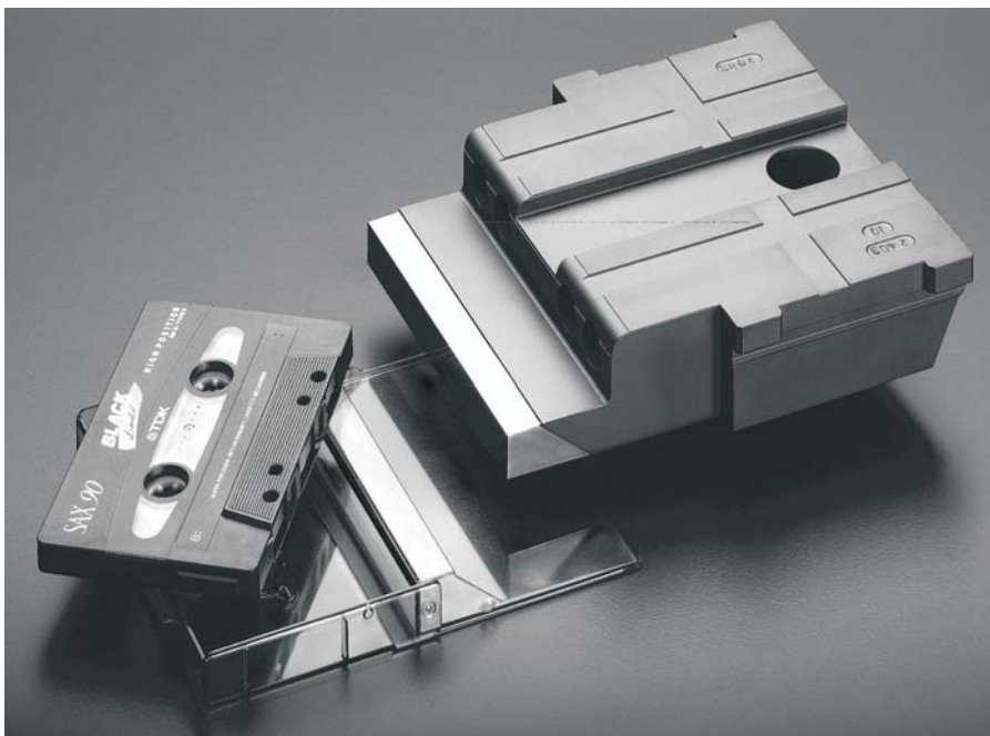
Slika 5: Zapiralni del orodja za brizganje plastike, zaščiten z ogljikovo prevleko z izjemno nizkim koeficientom trenja. Orodju, ki se uporablja v proizvodnji magnetnih trakov, se je obstojnost povečala za štirikrat.
