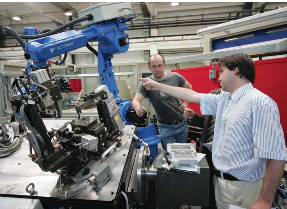
Slika 2: Aljoša Zupanc razlaga delovanje robotizirane celice. V ozadju je Robert Bolha, ki je programiral robote za varjenje in rokovanje z materialom.
