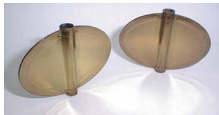
Slika 6: Dozirne lopute iz kompozita, ojačane z ogljikovimi vlakni, ki so bile s hibridnim postopkom PLD prekrite pri sobni temperaturi z večplastno prevleko iz TiN
