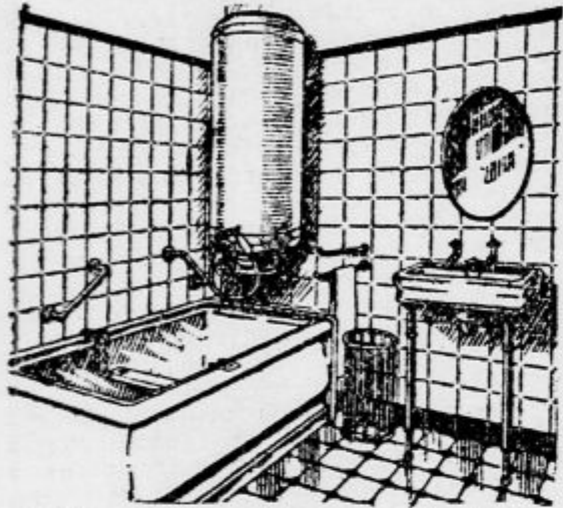
Boiler za 150 l vroče vode v kopalnici
