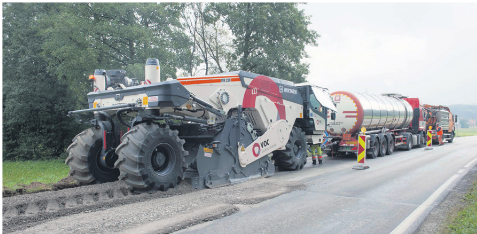
Velika letošnja pridobitev Voca je reciklator za asfalt. Takšen stroj, ki je stal malo več kot milijon evrov, ima trenutno le še eno podjetje v Ljubljani.
