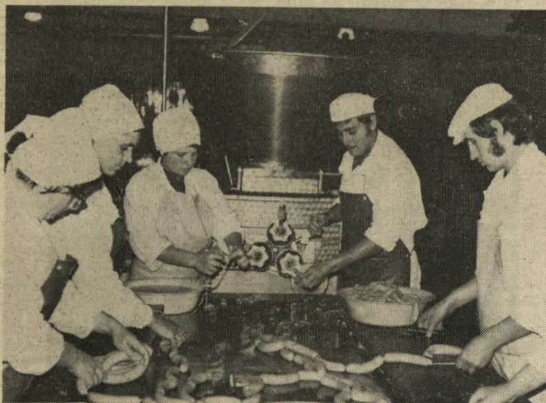
Največja pridobitev obrata Mesnine v letu 1972 je polnilni stroj VEMAG ROBOT 3000 S, ki bo s svojo dovršenostjo in avtomatizacijo mnogih delovnih operacij pripomogel, da bo PE predelava lažje izpolnjevala svoje proizvodne obveze
