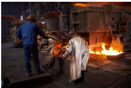
Začetek ulivanja na kontinuirni napravi
