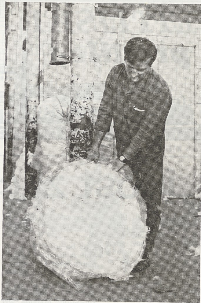
Bala malon vlakna, predvidena za reklamacijo. Vlakno bi moralo biti belo, a je o tej barvi bolj malo sledu — iz takšne surovine ne more biti kvalitetnega izdelka
