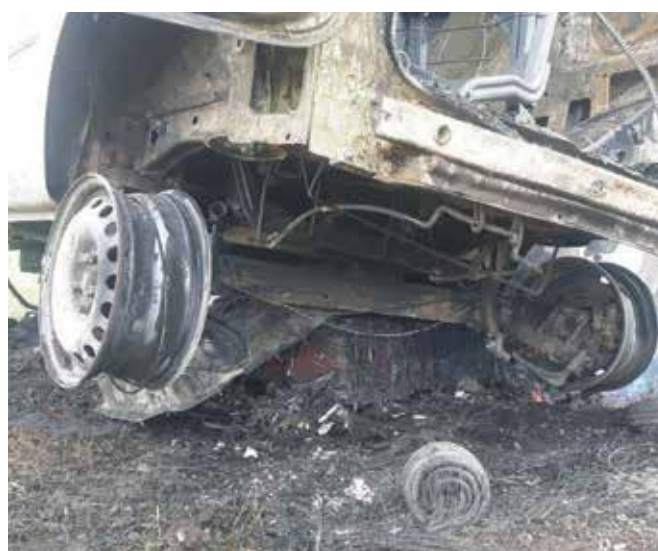
Odpadla goreča baterija po eni uri gorenja s poskusom pogasitve
