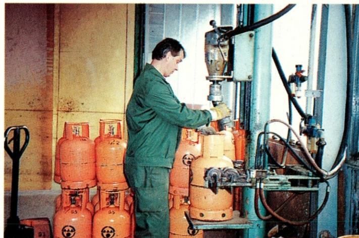
Po preskusu trdnosti z vodnim tlakom na 25 barov je potrebno zaviti ventile.
