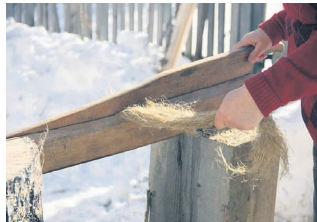
Trlica za trenje lanu, za pridobivanje lanenega prediva, ki ga je nato treba počesati in mikati.
