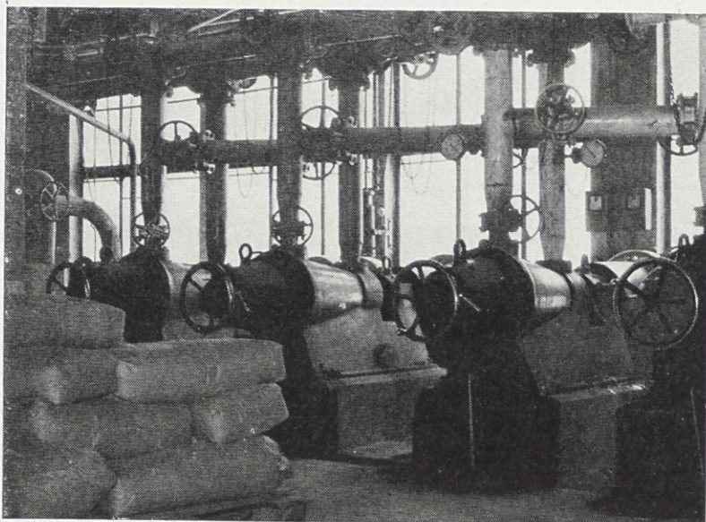
Sodobne mlevne naprave »rafinerji« za mletje snovi za karton
