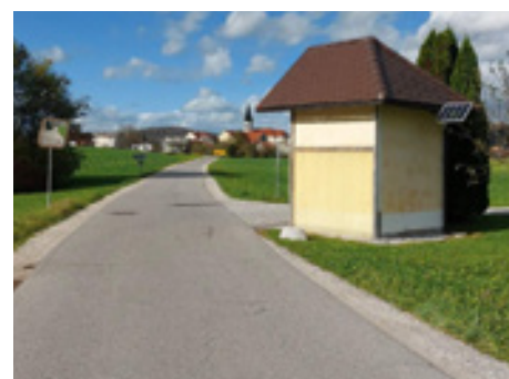
Slika 1: Pogled iz avtomobila, na razdalji 20 metrov do kapelice, ko v hipotetični situaciji izza kapelice na cesto steče otrok na poti iz šole. Pri predpisani hitrosti 40 km/h bi varno ustavili pred otrokom. Pri preveliki hitrosti 60 km/h bi trčili v otroka s hitrostjo dobrih 50 km/h.
