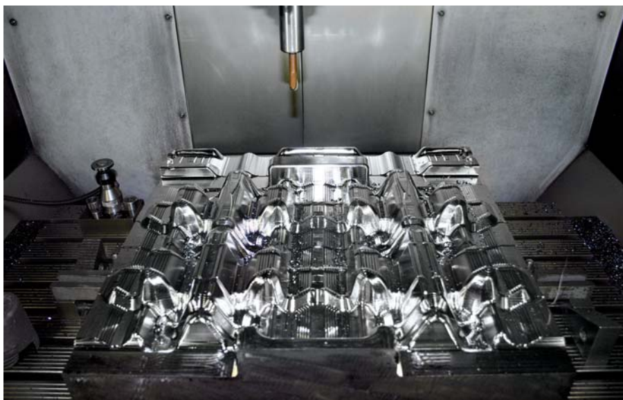
Kompletna obdelava večgnezdnih orodij za kovanje tečajev vrat malih tovornjakov
