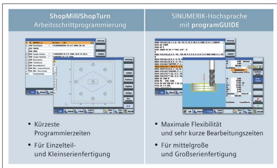
6. SinumerikOperate daje na razpolago tri metode programiranja: ShopMill/ShopTurn, programGuide in DIN/ISO z jezikom Sinumerik.
