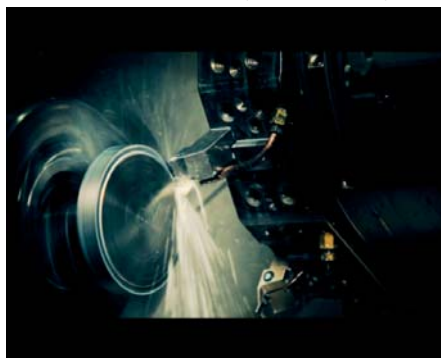
Primerjava konvencionalnega in kriogenega procesa struženja
