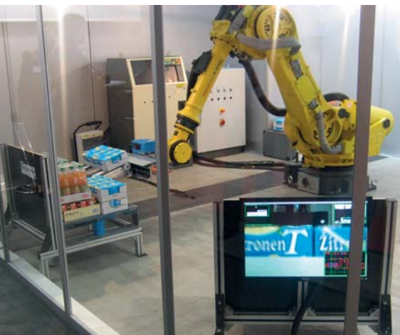
Slika 7: Robot s posebnim prijemalom za samodejno nalaganje kartonov z blagom
