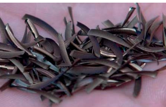
Slika 3: iDrezki – konstantna debelina vzdolž celotne poti
