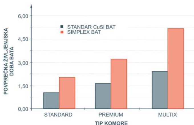
Slika 9: Primerjava življenjske dobe standardnega bata iz baker-silicijeve zlitine in bata SIMPLEX v odvisnosti od tipa livne komore
