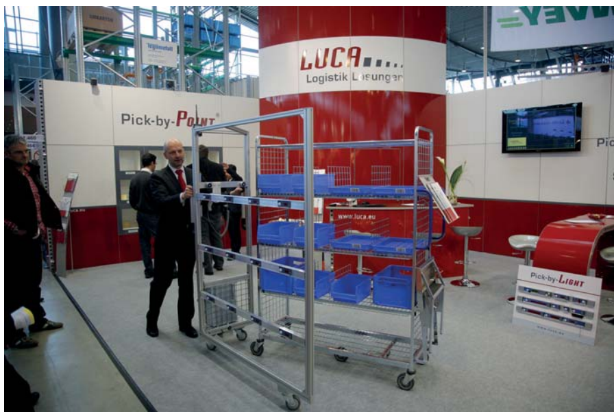
Slika 2: Sistem izbiranja v okvirju (pick-by-frame) z zamenljivim okvirjem na vozičku za nabiranje
