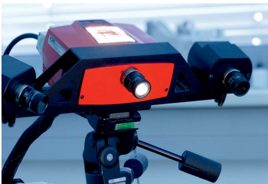
Slika 5: Optični digitalizator na belo svetlobo ATOS II podjetja GOM iz Nemčije, ki je skupaj s pripadajočo programsko opremo GOM Inspect trenutno v svetu vodilni proizvod za v članku predstavljene meritve.
