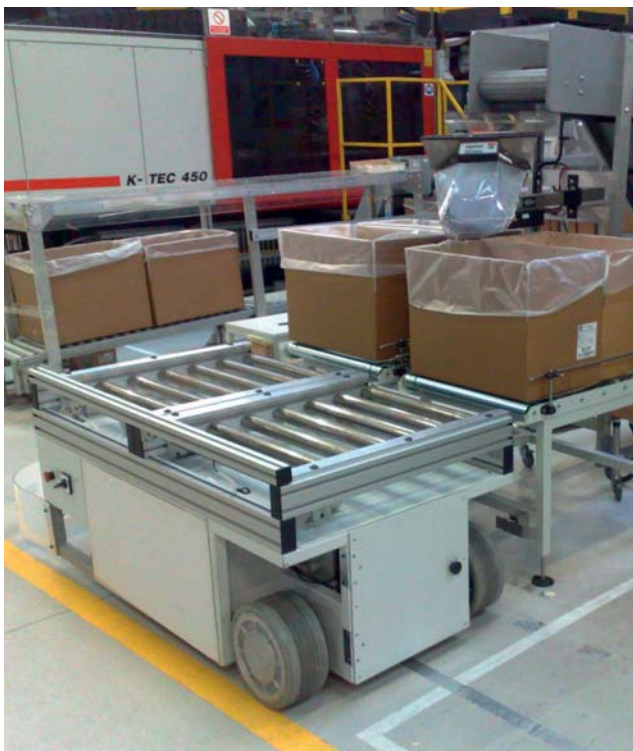
Slika 8: Avtomatska menjalna mesta s samodejno vodenim vozičkom
