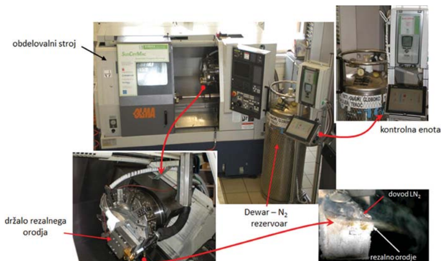
Adaptacija kriogenega odrezavanja na konvencionalni obdelovalni stroj
