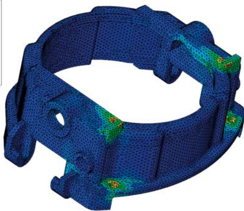
Jarem elektromotorja: Napoved napetosti med obratovanjem z upoštevanjem dejanske orientacije steklenih vlaken kot polnila osnovnega materiala. (naročnik: BSH)
