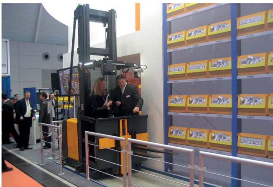
Slika 6: Regalni viličar s posebno opremo za podporo delu voznika na vožnji na lokacijo in na sami lokaciji
