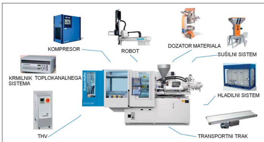
Slika 5: Priprave, ki nastopajo v procesu izdelave izdelka iz plastičnih mas in tvorijo proizvodno brizgalno celico
