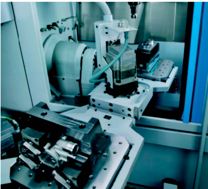
Opcijsko NC-krmiljena avtomatska zamenjava palet z ničelnotočkovnim vpenjalnim sistemom z visokonatančno ponovljivostjo (obdelava brez posluževanja)
