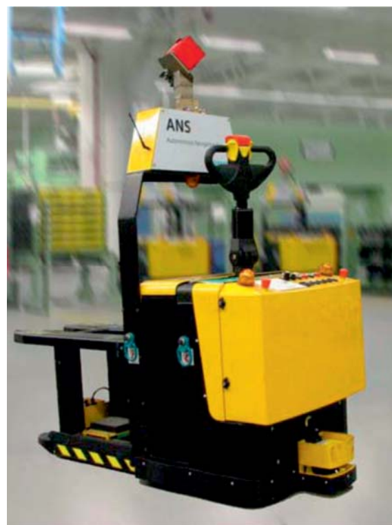
Slika 5: Sistem ANS lahko namestimo na različne velikosti in tipe električnih viličarjev za notranjo logistiko.
