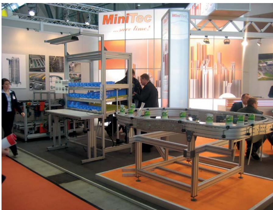
Slika 1: Aluminijasti profili so osnova za različno logistično opremo, kot so paletni transportni sistemi, delovna mesta in tekoči trakovi.
