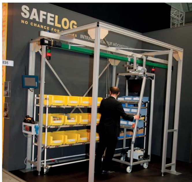
Slika 3: Nabiranje blaga s sistemom za natančno merjenje položaja vozička
