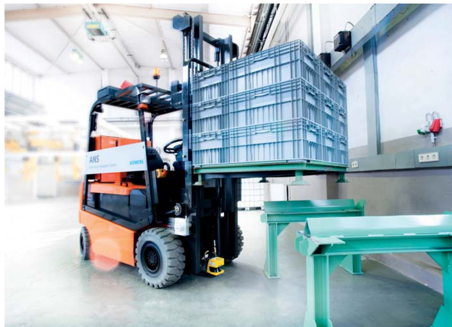
Slika 4: Viličar za samodejno vožnjo, pa tudi nakladanje in razkladanje, je opremljen z avtonomnim navigacijskim sistemom in dodatnimi zaznavali za prepoznavanje ovir in predmetov v okolici.
