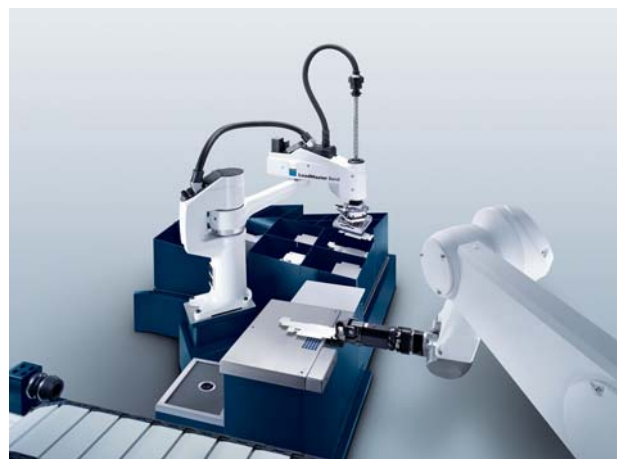
Komponente avtomatizacije, kot je LoadMaster Bend, lahko razvrščajo gotove izdelke v zaboje ali pa jih odstranjujejo po tekočem traku.
