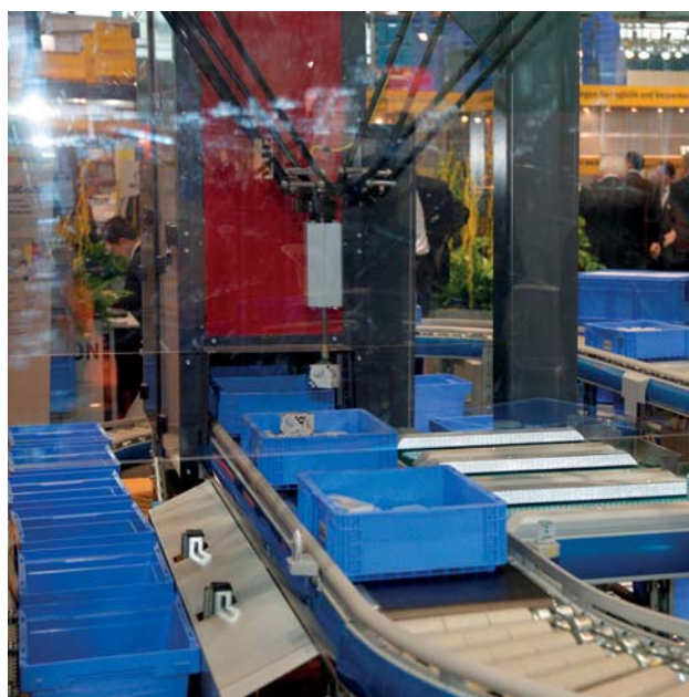
Slika 15: Popolnoma avtomatizirana celica Schäfer Robo Pick za komisioniranje z robotom
