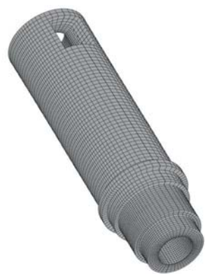
Slika 4: (a) 3D-model livne komore, (b) primerjava eksperimentalno izmerjenih in izračunanih temperatur za prve livne cikle
