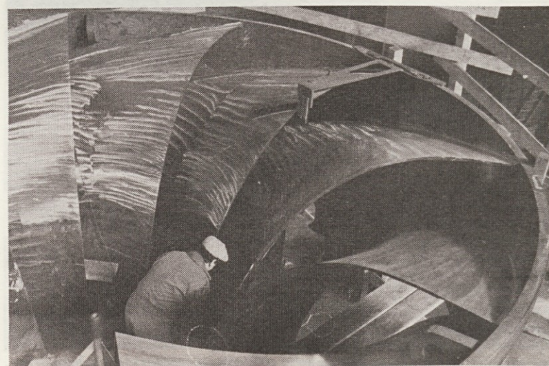
Končna kontrola zvarov z ultrazvokom na gonilniku za HE Stratos
