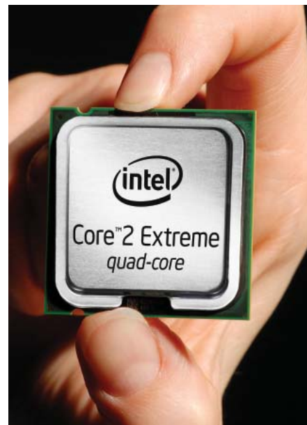
Tehnologija 45 nm na delu: novi štirijedrni procesor Core 2 Extreme z do nedavno kodnim imenom Penryn (Intel)
