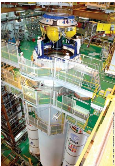
ATV Jules Verne inženirji pripravljajo za dvig in postavitve na krov Ariane 5. (Foto:ESA /CNES/Arianespace)
