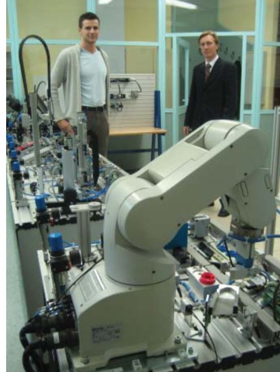
Veriga devetih samostojnih sodobnih izobraževalnih enot za avtomatizacijo različnih postopkov izdelave, sestavljanja in rokovanja z materialom, ki jih lahko združimo v zapleteno proizvodno linijo
