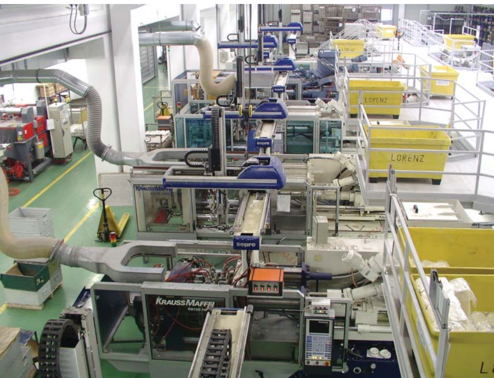
Slika 1: Proizvodna hala s stroji za brizganje BMC-mas v podjetju Domel, d. d.
