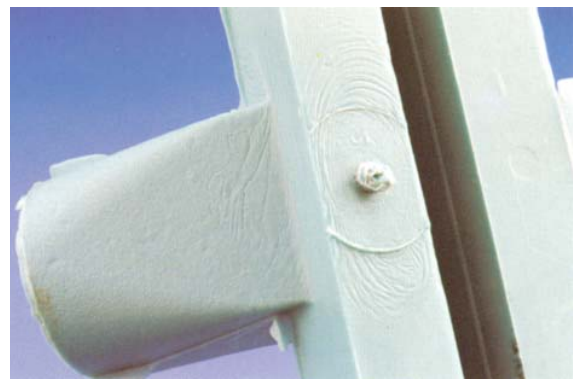
Slika 9: Brazde okoli dolivka pri debelih izdelkih (vir: K.I.M.W. GmbH)
