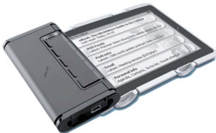
Neuničljiv in upogljiv »zaslon«: model mobilne naprave s »papirnim« zaslonom (Polymer Vision)
