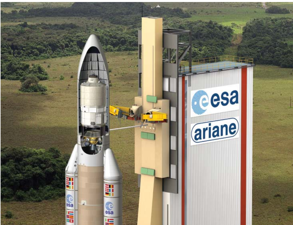
Za izstrelitev ATV, ki tehta več kot 19 ton, je potrebna posebej prilagojena nosilna raketa Ariane 5. (Foto: ESA - D.Ducros)
