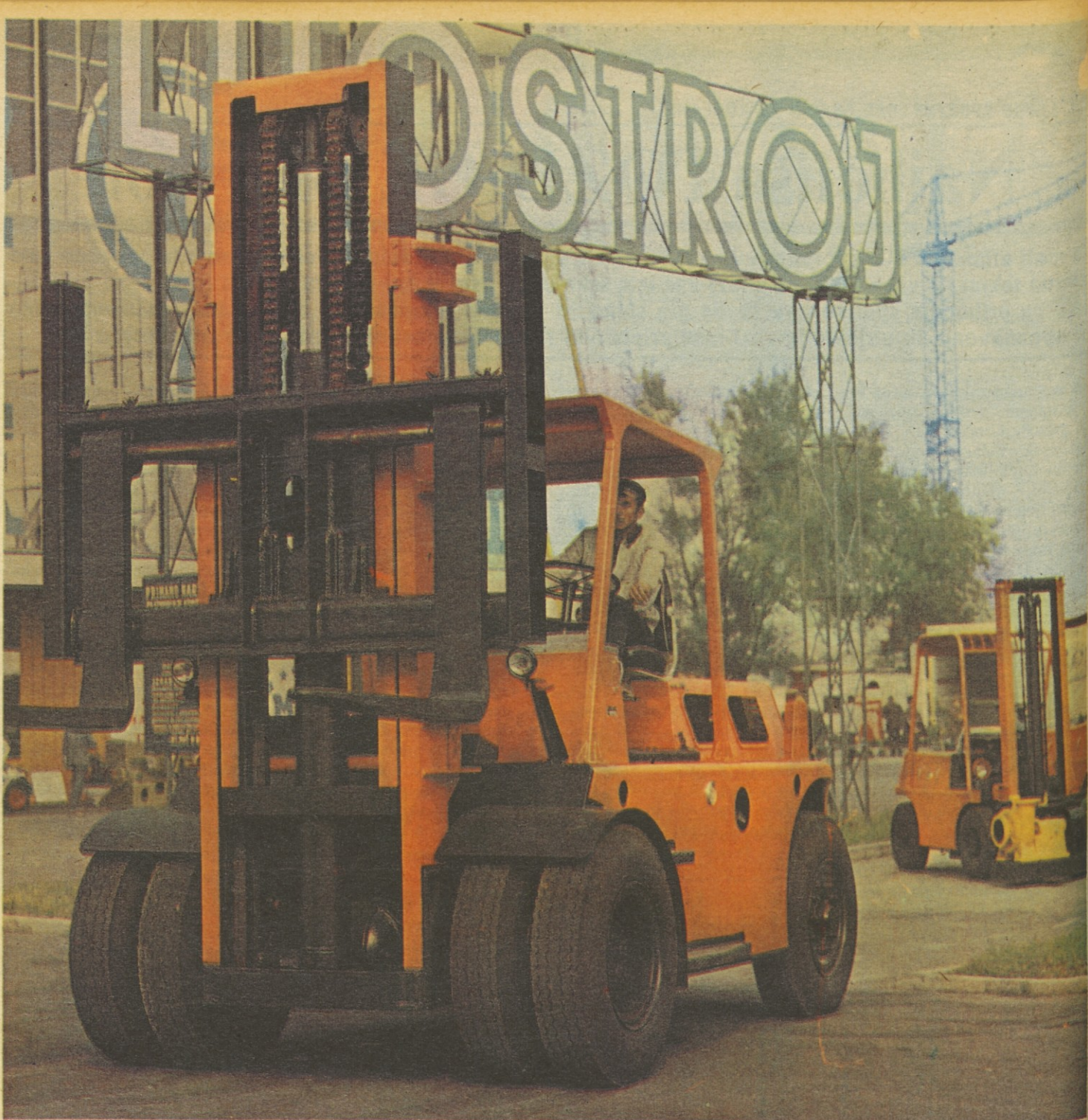
Moč in natančnost pri delu - dvajsettonski Litostroj viličar
