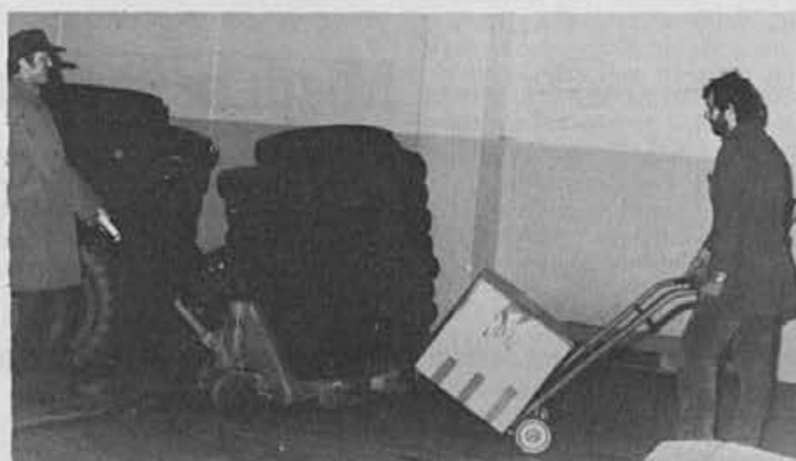
Ročni viličar levo kot voziček in »rudl« desno sta zelo pripravi sredstvi za prevažanje
