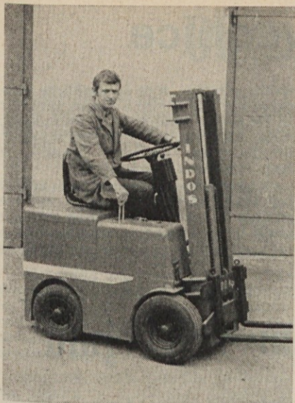
Baterijski viličar na poskusni vožnji. Služil bo za transport v novi predilnici in je prvi stroj, ki smo ga za predilnico že dobili v tovarno
