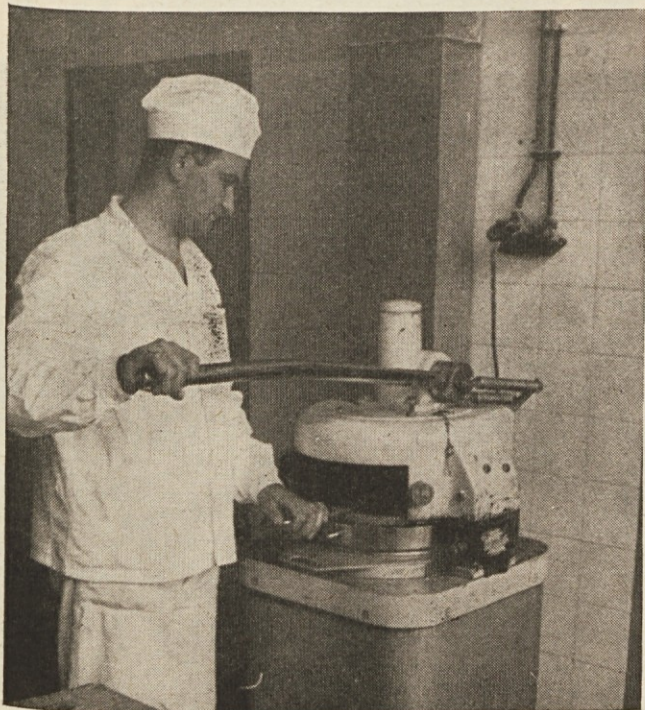
Takšen je polavtomatični stroj za izdelavo peciva
