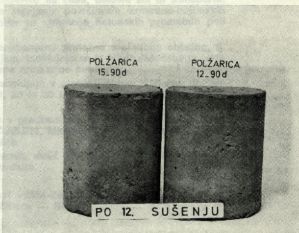
Slika 3. Laboratorijski preizkušanci stabilizacijske mešanice barjanske polžarice in hidratiziranega apna po končani preiskavi vremenske obstojnosti z namakanjem in sušenjem
