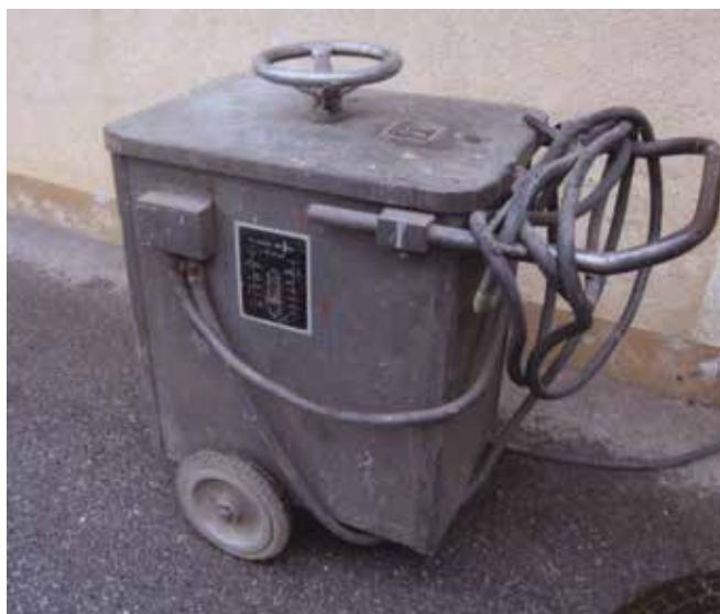
59. Varilni transformator FURLAN Črnuče-Ljubljana TO-250A, izdelan okoli leta 1966, ki ga še danes uporabljajo v delavnici Elektro Ljubljana-nadzorništvo Vrhnika (Foto Janez Žitko, 2017).
