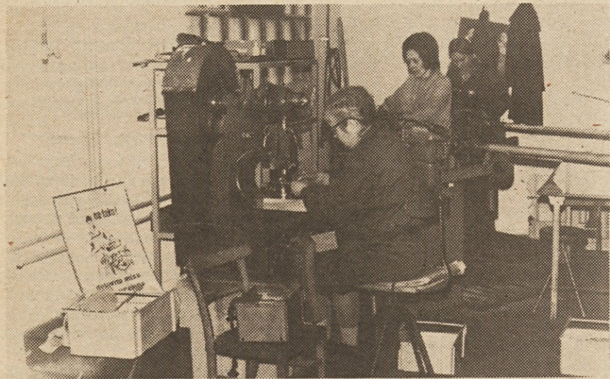
Izdelovanje polizdelkov za antene na polavtomatskih strojih.
