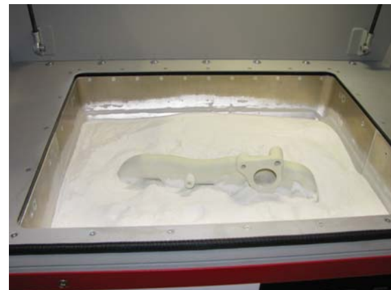
VoxelJet VX 500, manjši od obeh modelov. Izdelovalna komora s prahom PMMA.
