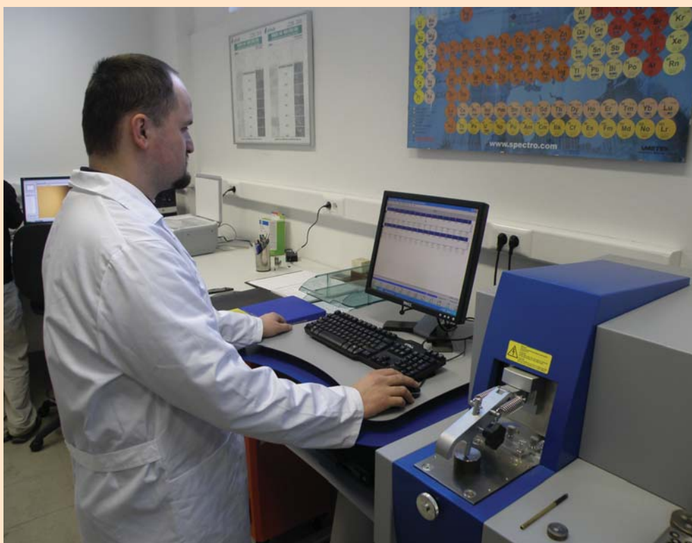
Spektrometer omogoča hitro in natančno analizo kemijske sestave jekel, aluminijevih in bakrovih zlitin.
