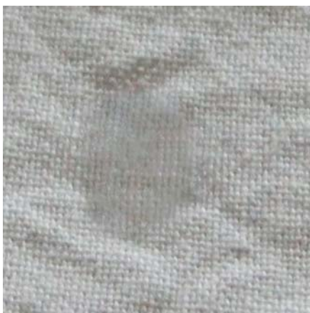
Slika 1: Neapretirana (A) in superhidrofobna apretirana (B) bombažna tkanina
