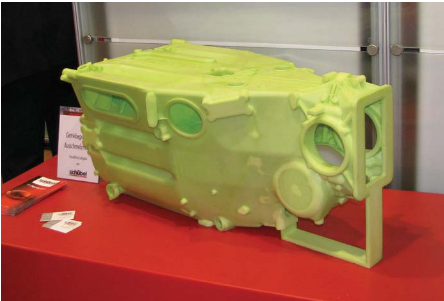
Izdelek iz PMMA, izdelan na VX 500
