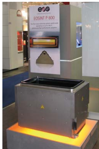
Novi P800 za obdelavo PEEK – skrivnost je v toplotni izolaciji in gretju delovne komore.
