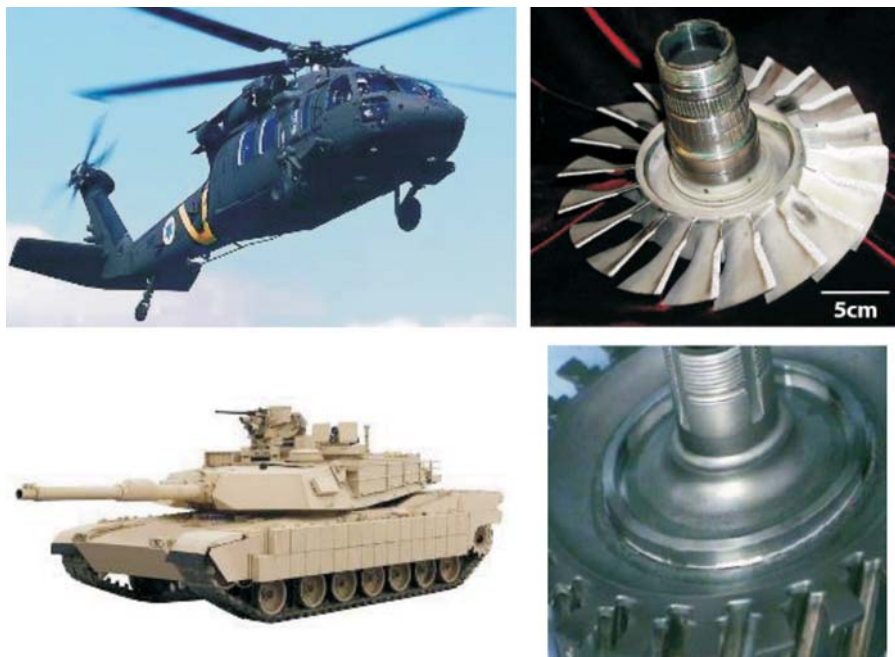
Slika 10: Popravila sestavnih delov za vojsko s tehnologijo LENS
