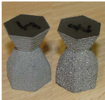
Prej in po: levo je prikazana hrapavost po uporabi funkcije MultiBeam, desno pa pred njo. Razlika je očitna, vendar za zobotehnično prakso še vedno ni dovolj.
