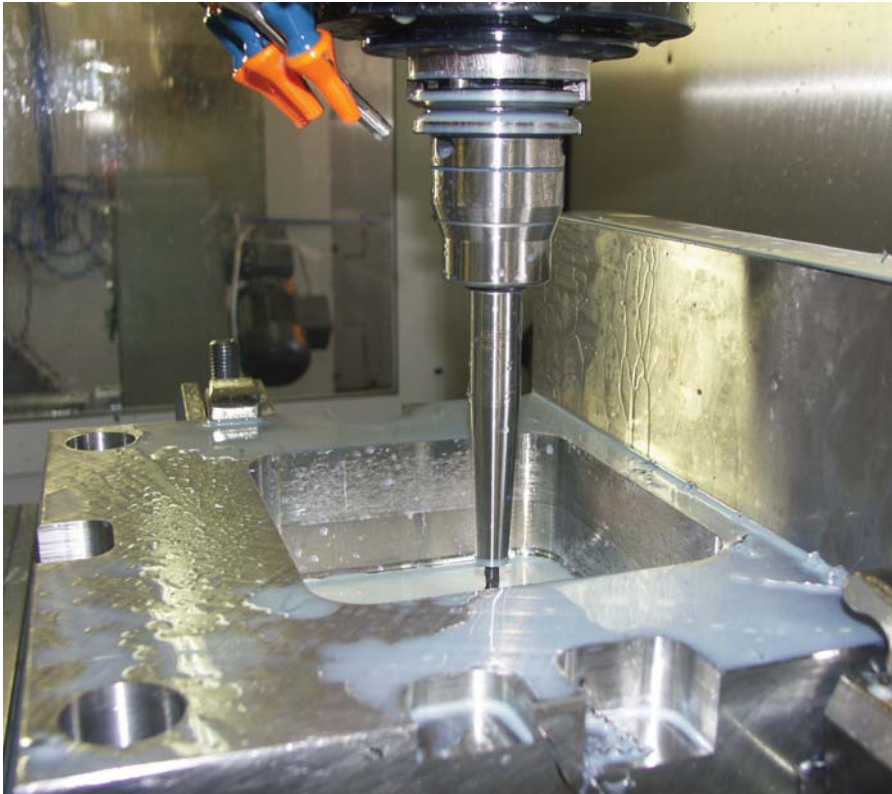
Slika 1: Zaradi vitke izvedbe podaljškov vpenjalnih glav je mogoče obdelati tudi globoke posode/tulce, vdolbine/reže in štrleče dele obdelovancev.
