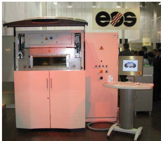
Novi P800 za obdelavo PEEK – skrivnost je v toplotni izolaciji in gretju delovne komore.
