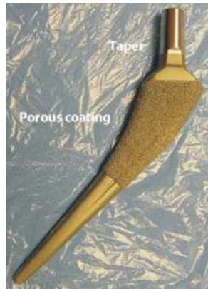
Slika 9: Sodobni medicinski implantati, narejeni iz titanove zlitine s tehnologijo LENS
