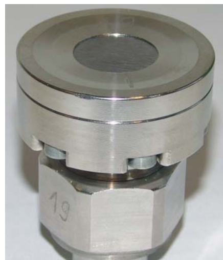
In-situ celica za strukturno analizo s pomočjo rentgenskih žarkov
