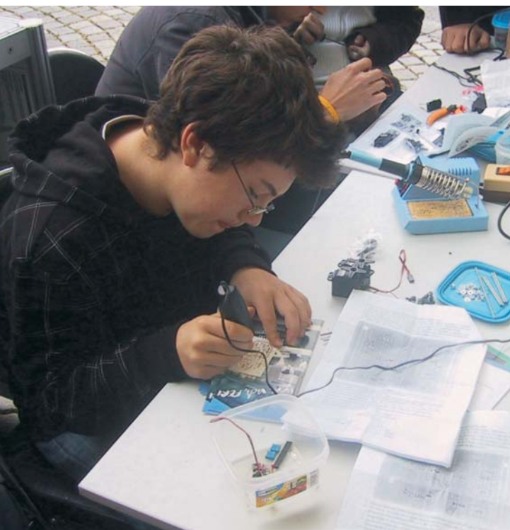
Pri izdelavi robota SLEDIbot moramo izvrtati luknje v tiskano vezje in elektronske elemente na tiskano vezje prispajkati.
