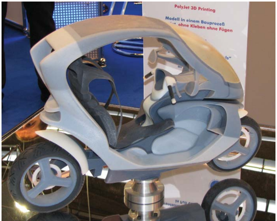
Model skuterja, narejen na Connex 500. Uporabljenih je bilo 21 različnih materialov v enem izdelovalnem ciklu, od elastičnih do raznih barv akrilov.
