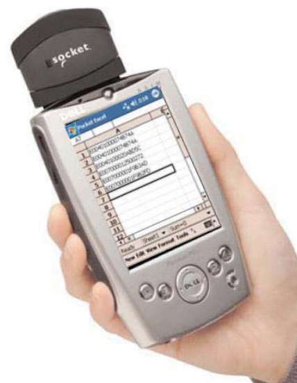
Slika 3: Ročni računalnik z dodatkom, čitalnikom RFID, ki ga vstavimo v rezo dlančnika ali terminala
