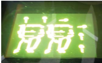
Projekcijski vir DLP obseva fotopolimerno smolo v obliki enega prereza 3D-modela
