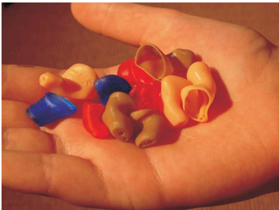
Slika 1 – Školjke slušnih aparatov po meri, izdelane po postopku RM
