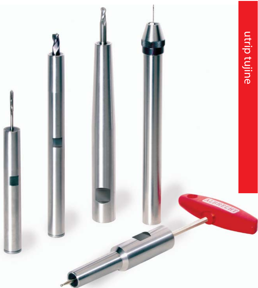
Slika 3: Novi podaljški vpenjalnih glav. Pri vseh izvedbah poteka vpenjanje orodij z zadnje strani in z osrednjim vpenjalnim vijakom.
