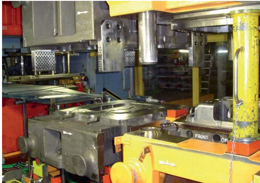
V prvi fazi (levo) se izvrši globoki vlek pločevinastega izdelka; sledita obrez izdelka in prebijanje lukenj v drugi fazi (desno).
