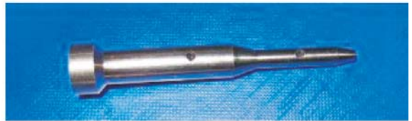
Slika 9: Sodobni medicinski implantati, narejeni iz titanove zlitine s tehnologijo LENS
