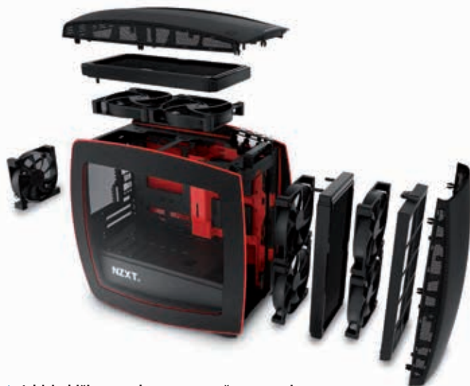
▲ Izbiri ohišja navadno ne posvečamo pretirane pozornosti. A tudi v majhna ohišja je moč vgraditi (skoraj) vse komponente, le nekoliko previdnejši moramo biti pri njihovi izbiri. Daljše grafične kartice pogosto ne pridejo v poštev.
