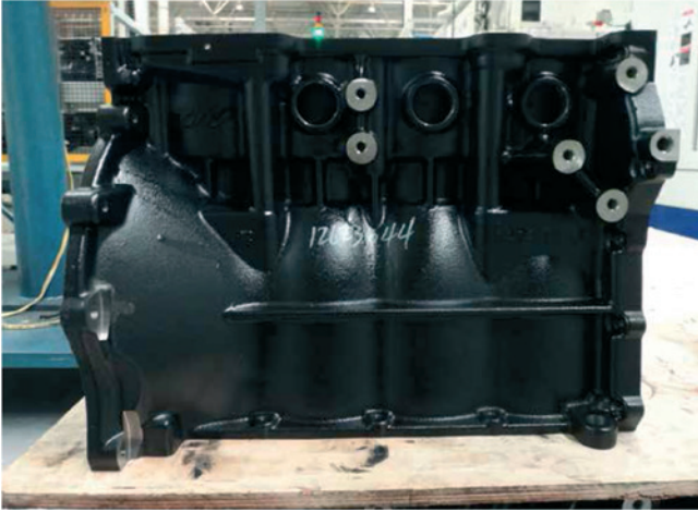
» Blok motorja narejen iz materiala HT250, ki je zelo podoben sivi litini in ima trdoto 180–220 HB.
