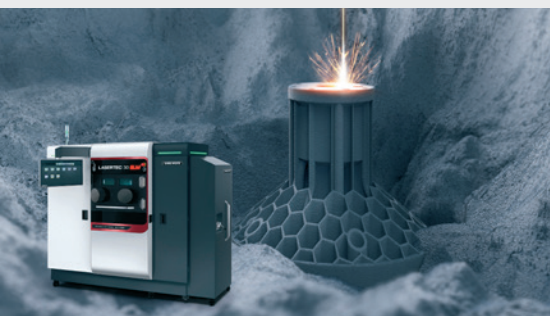
» Na trgu sistemov za aditivno tehnologijo stroj LASERTEC SLM navdušuje z visoko stopnjo procesne zanesljivosti in učinkovitosti. Njegov modul za menjavo materiala omogoča kompletno zamenjavo prahu v manj kot dveh urah.
