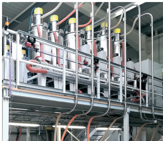
» Slika 3: Pogled na centralni sušilni in transportni sistem, ki je dvignjen in ne zavzema »delovnega« prostora brizgalkam
