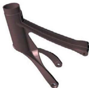
» 1. CAD-model nosilca sedežne cevi, zasnovanega za litje iz aluminijeve zlitine
