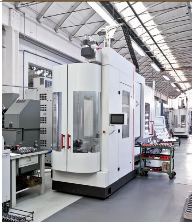
» Pogled od spredaj na postajo za pripravo sistema za skladiščenje in menjavanje palet PW 150, ki je priključen na obdelovalni center C 22 U.
