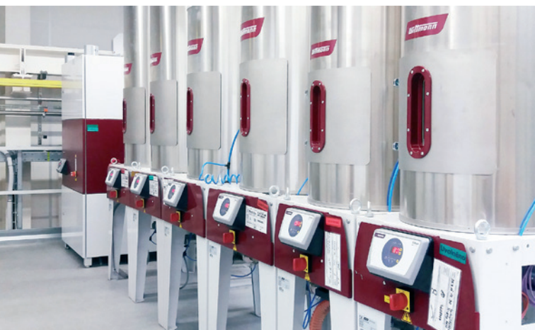
» Slika 1: Sušilni silosi na suh vroči zrak s centralno pripravno enoto
