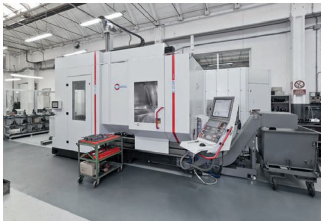
» Eden od dveh petosnih obdelovalnih centrov C 22 U (sredina) v tovarni Fausti. Levo je sistem za skladiščenje in menjavanje palet PW 150, desno pa dodaten zalagovnik ZM 43.
