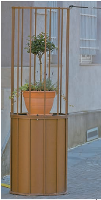
Foto: CG Okrasni steber, v katerega so namestili (skrili) črpalko in krmilni sistem, je stal 2.400 evrov.
