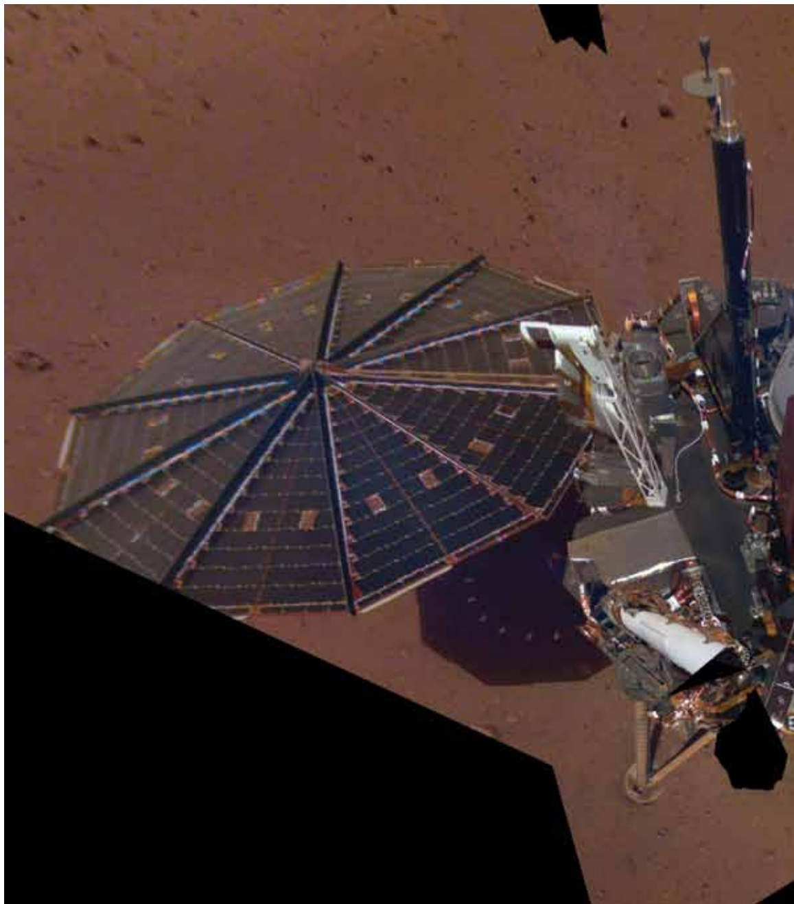
To je prvi »avtoportret« sonde InSight na Marsu, ki je bil posnet 6. decembra letos. Na njem vidimo sončni plošči in krov. Na vrhu krova so znanstveni inštrumenti, senzorji za zaznavanje vremena in UHF-antena.
