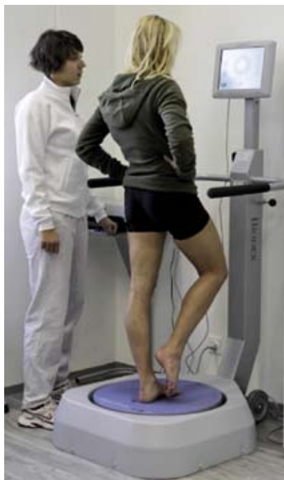
Slika 1: Merjenje ravnotežja na napravi BiodexBalanceSystem.
