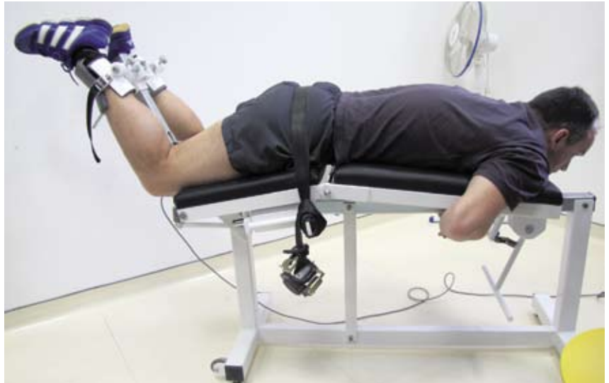
Slika 2: Meritev največjega navora in največje hitrosti prirastka navora v statičnem dinamometru za upogib kolena.
