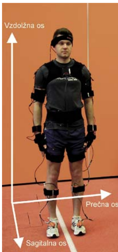
Slika 1: Inercialna obleka MVN v običajni laboratorijski postavitvi senzorjev gibanja. Na sliki so označene tudi osi, kot se uporabijo pri analizi podatkov.
