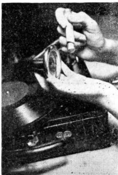
„Slanik“ za gramofonske igle je mala naprava koja je tako udešena da pro- pušta jednu iglu kada se pritisne
