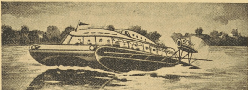
Veliki hidroglisér „Meteor“, ki so ga projektirali za brzo vožnjo po Renu. Njega največja gaz bo komaj 20 cm. Zato ga ne bo ovirala tudi najnižja voda.
