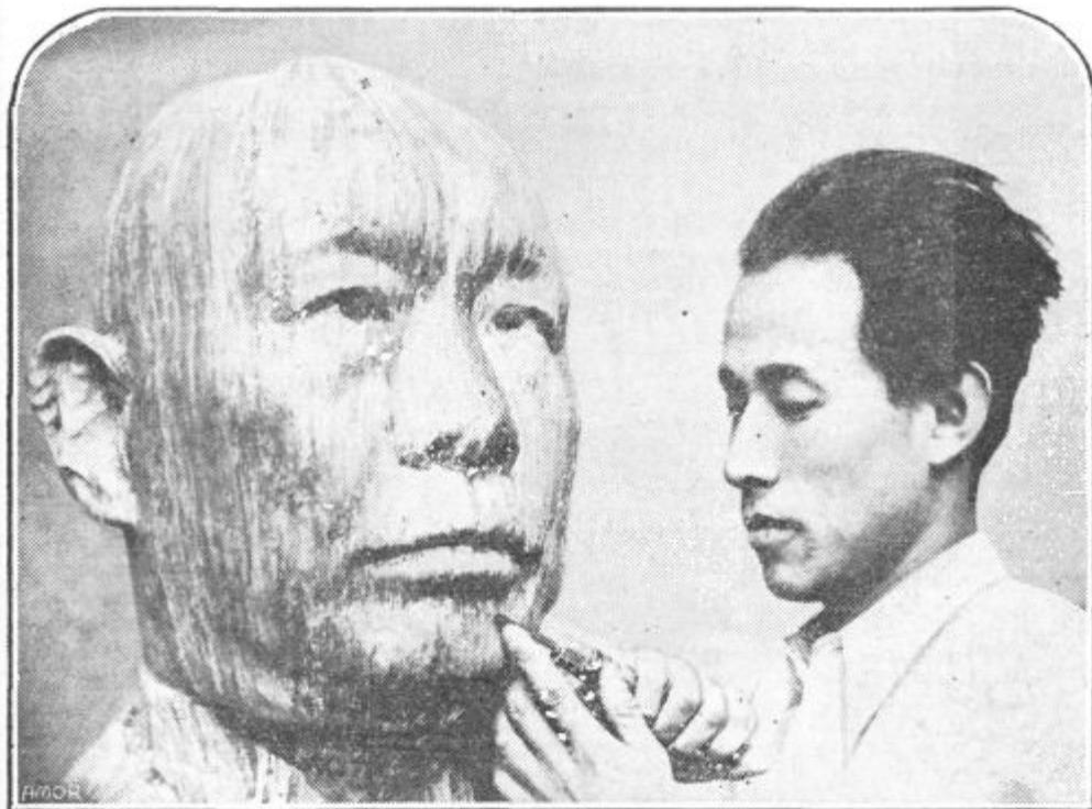
Izumitelj Morioka pri retuširanju s parafinom napolnjene oblike, ki jo je dosegel po svojem trodimenzionalnem fotografskem postopku
