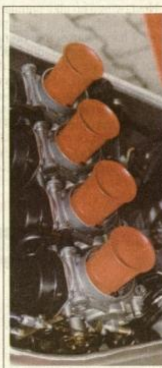
Štirivalnik s štirimi mem- branskimi uplinjači in štiri- mi vžigalnimi tuljavami zmoro 110 konjev, kar je do- volj za 245 km/h.
