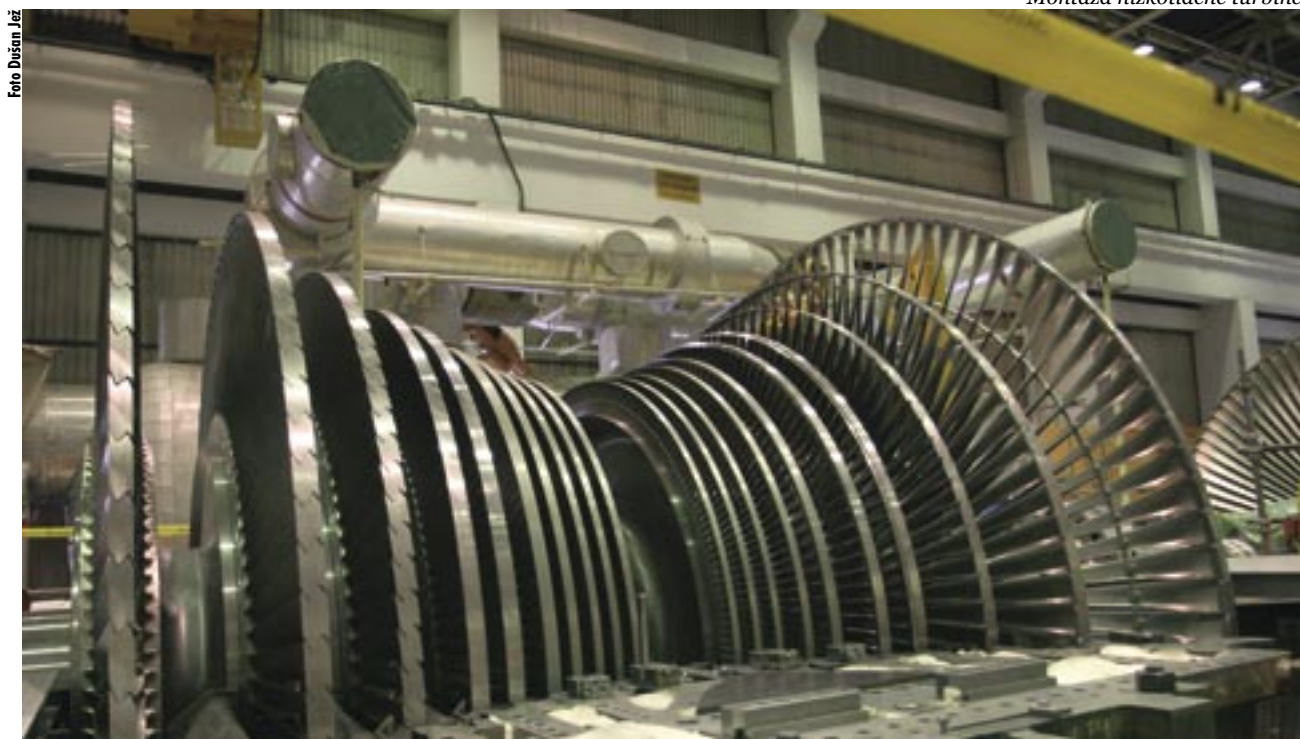
Montaža nizkotlačne turbine.
