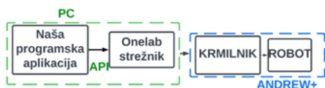
Slika 2: Konfiguracija krmiljenja in programiranja robota
