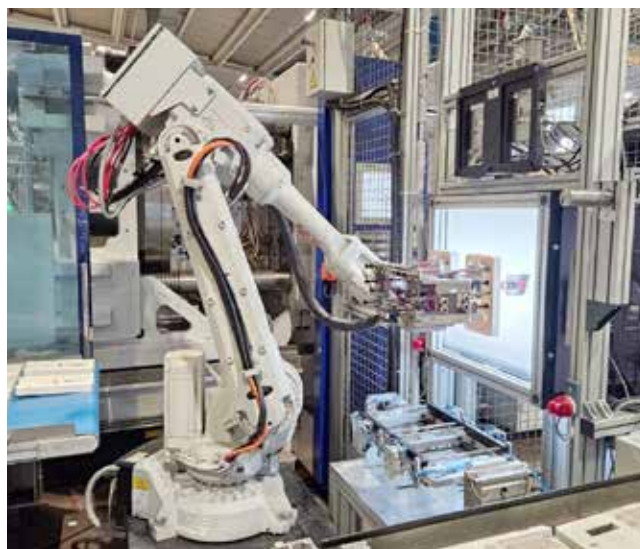
Slika 4 : Ineina nadgradnja robotske celice z AI osnovano kontrolo ustreznosti izdelkov v plastiki Skaza
