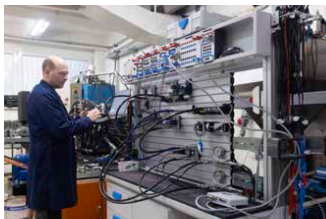
Slika 2 : Raziskovalna oprema za diagnosticiranje hidravličnih komponent in sistemov (Foto: IFP, d. o. o.)
