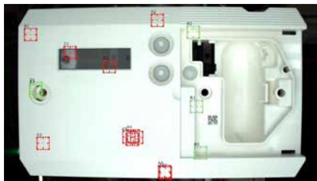
Slika 2 : Primer izdelka z več različnimi napakami in rezultat avtomatske AI analize
