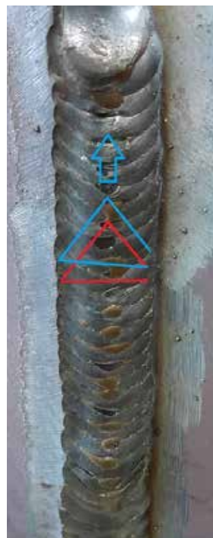
Varjenje vertikale navzgor – prekrivni zvarni spoj
