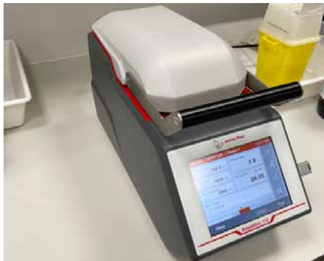
Slika 2 : Naprava RapidOxy 100 za določanje oksidacijske stabilnosti
