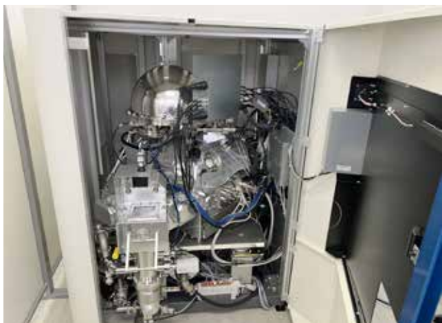
Slika 1 : Visokoresolucijski spektrometer XPS za tribokemijsko karakterizacijo mejnih mazalnih filmov in površin z mikrometrsko natančnim pozicioniranjem in analizo (Foto: arhiv Laboratorij za tribologijo in površinsko nanotehnologijo TINT)
