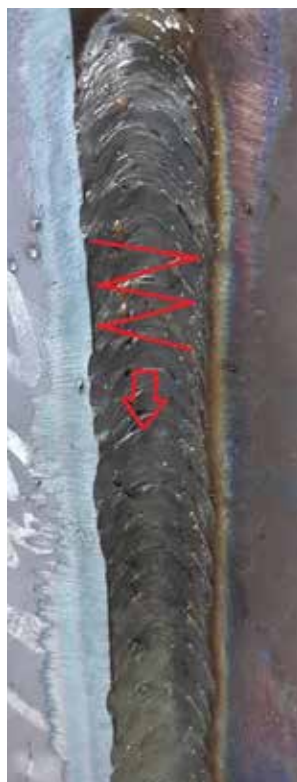
Varjenje vertikale navzdol
