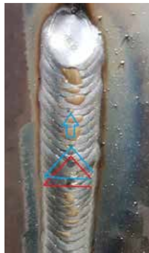
Varjenje vertikalne navzgor – kotni zvarni spoj
