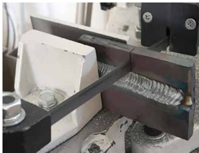
Preiskava zvarnega spoja MIG MAG
