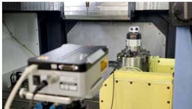
Slika 3 : Visokonatančni 6-osni laserski merilni sistem za umerjanje in diagnostiko obdelovalnih strojev (Foto: arhiv UL Fakultete za strojništvo)
