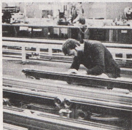
V Vzdrževanju izdelani in tudi patentirani taktno sklopljeni transporterji bodo kmalu preselili v obrat Hladilniki. Nova je tudi dvizna naprava.
