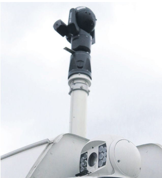
Vozilo je nekoliko višje, kamere, ki so nameščene na njem, lahko s hidravliko dvignejo tudi do štirih metrov. Zato policisti lahko takšno vozilo uporabljajo tudi v drugih situacijah, kot so javne prireditve, kjer kamere posnamejo več dogajanja v okolici.
