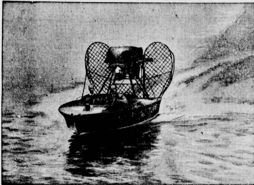
Von George P o s t ist jetzt ein neues Motorboot konstruiert worden, das sehr breit gebaut ist und infolgedessen fast gar keinen Tiefgang hat. Der Antrieb erfolgt nicht durch
