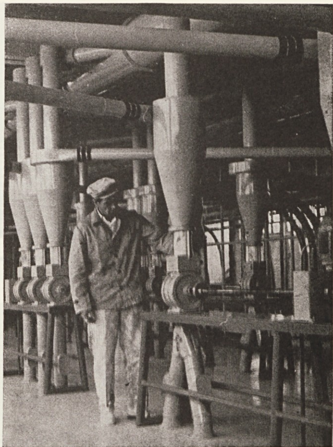
Delavec pri zračnih zaustavah s cikloni
