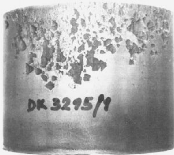
Slika 10: Drobljenje površine valja iz jekla BRM 2 Figure 10: Crushing of roll surface of steel BRM 2
