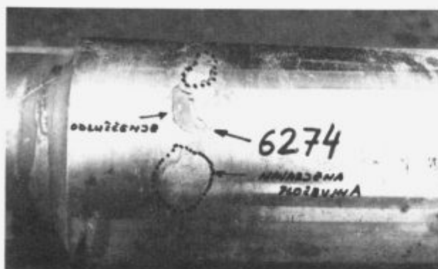
Slika 2: Navarjanje materiala na površino valja iz jekla OHV 4. Figure 2: Welded material on roll surface of steel OHV 4.
