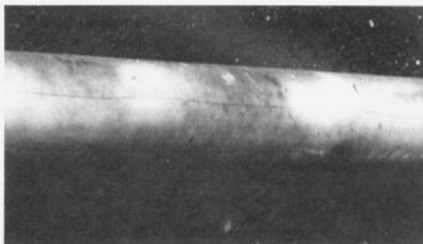
Slika 3: Vzdolžna razpoka na površini valja iz jekla Utrop Mo 6 Figure 3: Longitudinal crack on roll surface of steel Utrop Mo 6
