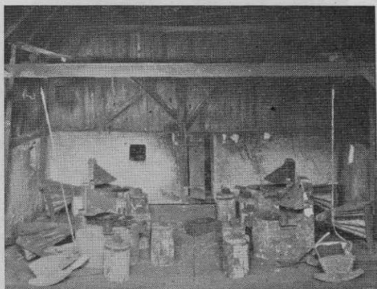
Maketa nekdanjega vigenjca v Železnikih z ločenimi mehovi in zibelko, privezано k mehu, da jo guglje
