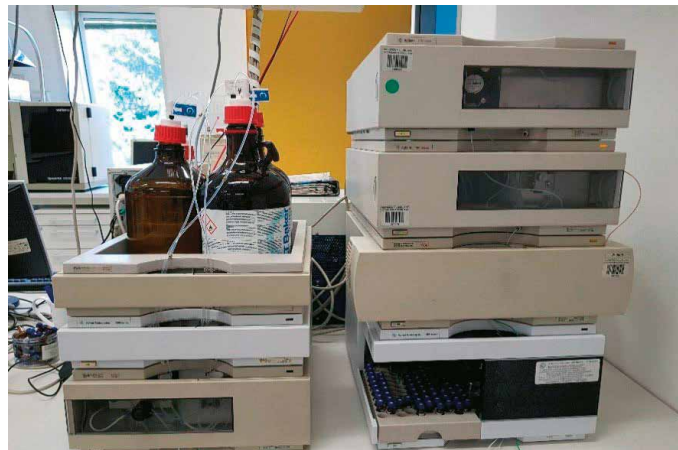
Slika 2: Sistem HPLC-FLD med analizo vzorcev medu na sulfonamide
