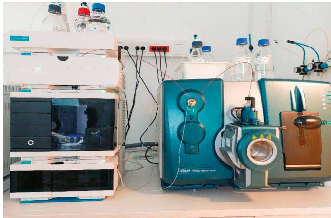
Slika 1: Tekočinska kromatografija s tandemsko masno spektrometrijo med meritvijo
