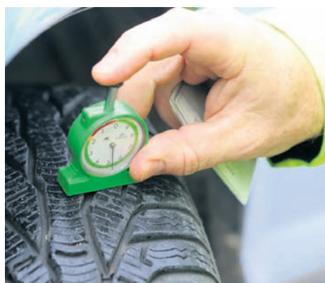
Takole izgleda meritev kanala na pnevmatiki, ko policisti uporabijo merilec profila.
