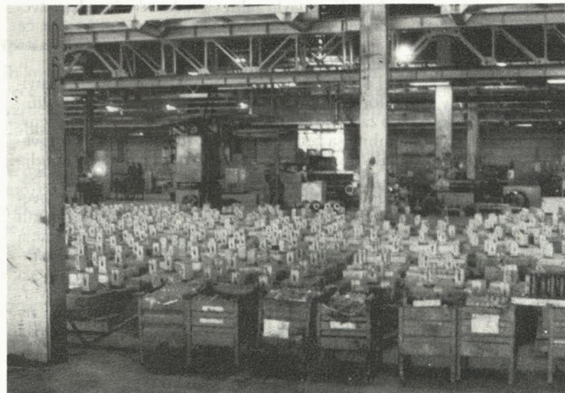
V hali vzdrževanja je izdelan tudi del opeke za ognjeodporno obzidavo nove koračne peči v Valjarni II
