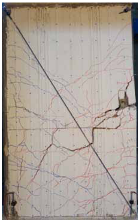
Slika 3 • Testiranje sten JUBHome WALL.
