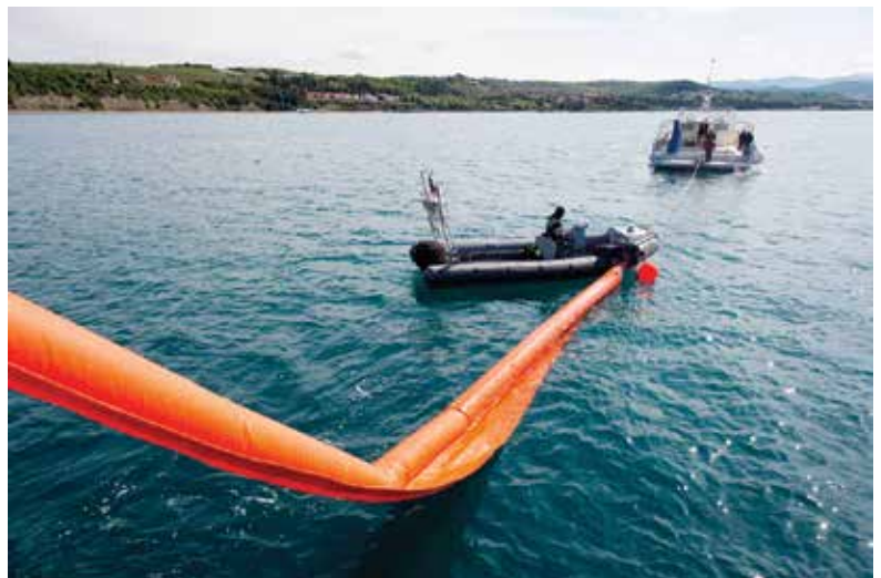
Morebitno izlitje bi zajezili s pomočjo vodnih baraž. / Nel caso di una perdita, questa verrebbe arginata con l'aiuto di barricate marine (vodnih baraž). (Foto: Bruno Toič)
