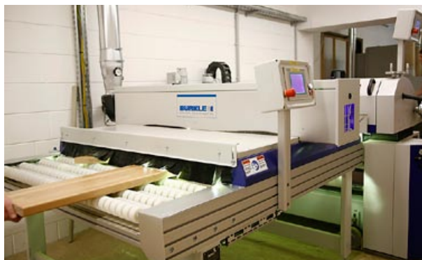
■ Slika 2. Obdelovance lahko prijemljemo in jih naprej obdelujemo takoj po izhodu iz linije
