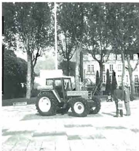
Sl. 4: Kmetijski traktor, ki ga poganja čisti alkohol (etanol). Foto: L. Žgajnar.
