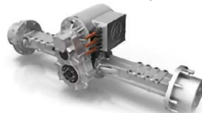
ZF-Etrac, centralni električni pogon tovornega vozila.
