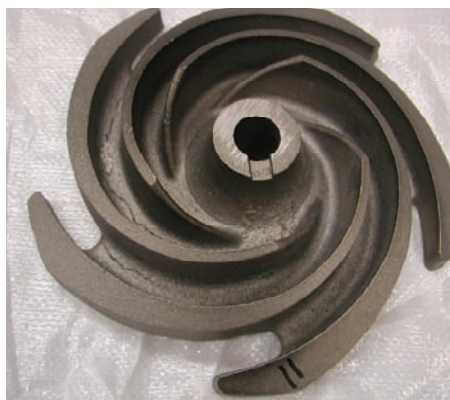
Slika 4. Ulita sesalna turbina z žilastimi razpokami
