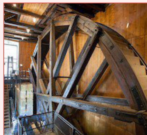
Kamšt je največje leseno kolo v Evropi, postavljeno v sedanji izvedbi okoli leta 1790 kot črpalna naprava za odvečno vodo v rudniku živega srebra (vir slike: muzej-idrija-cerkno.si).
